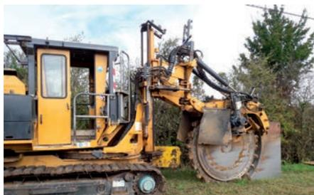
Une puissante machine a été utilisée pour réaliser l'enfouissement d'une partie du réseau de fibre.
